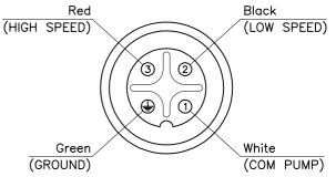
PUMP SUPPLY CIRCULAR CONNECTOR FRONT VIEW
